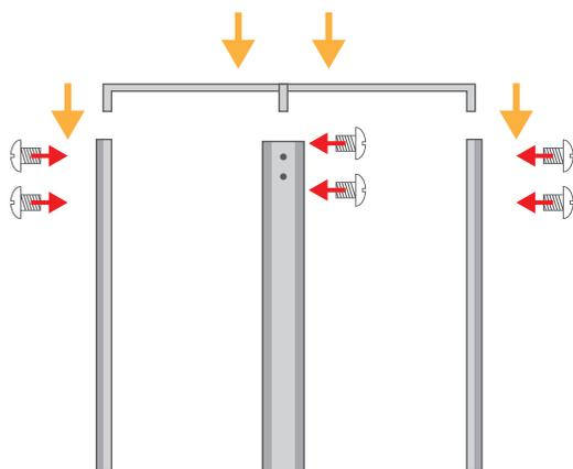
3. Applicare la staffa all'estremità superiore delle spalle e fissare con le viti in dotazione.
