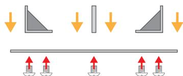
1. Applicare le tre angoliere alla piastra di base e fissare con le viti in dotazione.
