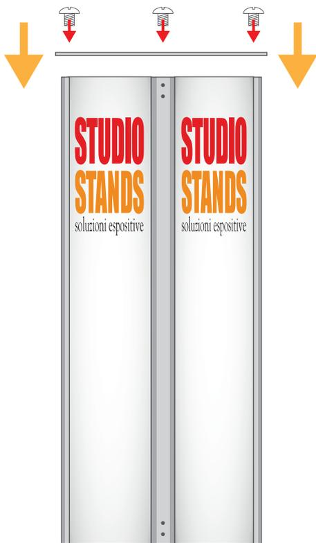
5. Applicare il coperchio superiore e fissare con le viti in dotazione.
