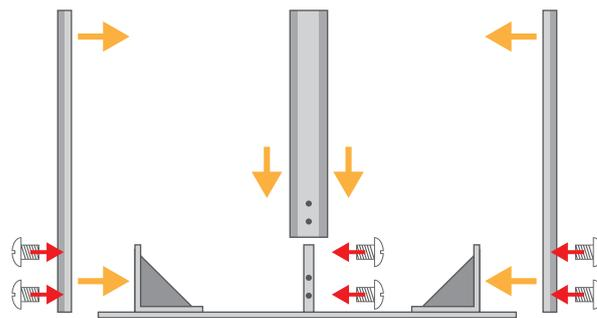
2. Applicare le spalle alle angoliere e fissare con le viti in dotazione.
